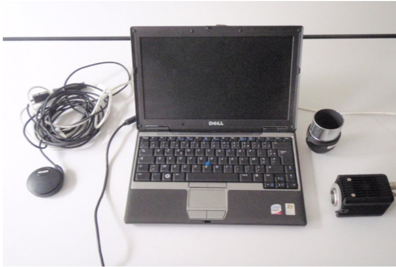
FIGURE 4.5 – Exemple du matériel nécessaire à l'observation. À gauche du terminal : l'antenne GPS nécessaire pour dater les images. À droite du terminal : Caméra CCD adapté à l'observation d'occultations stellaires (modèle Raptor/Merlin)
